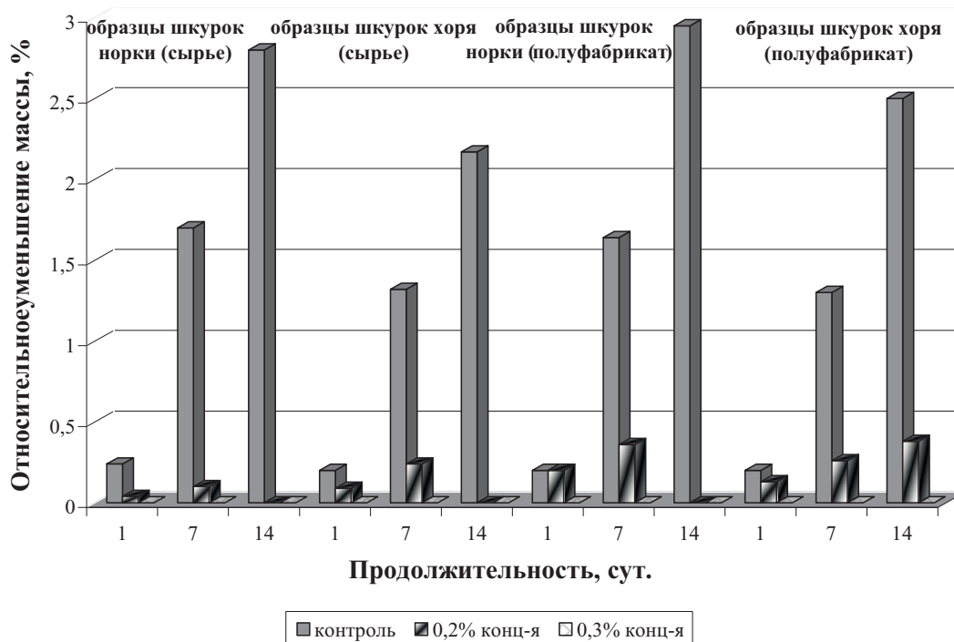
Рис. 2. Потеря массы образцов некоторых видов сырья и полуфабриката животного происхождения в зависимости от времени контакта с гусеницами моли
