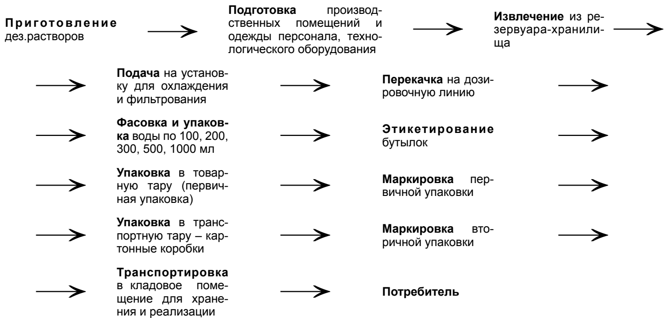
Рис. Технологическая схема производства «ДОСО-вода» для животных
